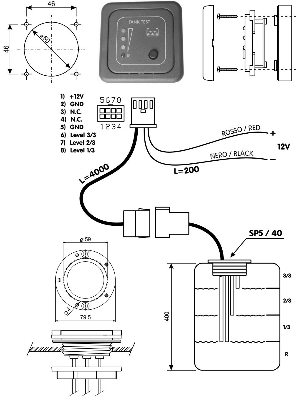
**I** **MTT** - Pannello test a 12V per il controllo del livello di un serbatoio dell'acqua potabile. Collegare il pannello alla sonda potabile "SP5/..." e all'alimentazione tramite l'apposito cavo rispettando le polarità come in figura.
